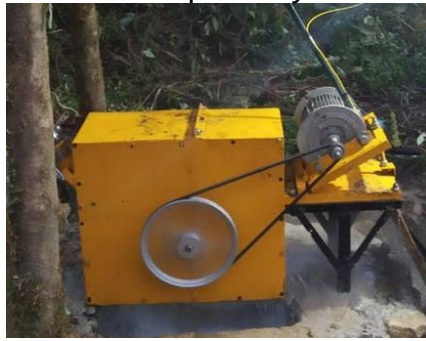
Figura 10 Sistema de poleas y bandas
