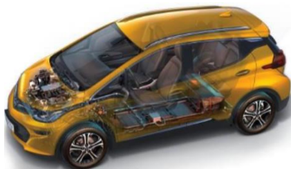
Figura 4. Distribución de elementos Opel Ampera, vehículo REEV . (Movilidadeléctrica.com, 2022)
