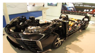
Figura 21. Plataforma de Toyota FCEV (PEGE, 2015).
