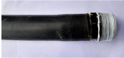
Figura 3 Manguera de regulación de caudal
