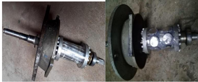
Figura 11 Motor modificado como generador
